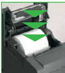
„Drop-In & Print“, einfaches Papier-nachladen entweder im standardmäßigen Horizontal- oder im platzsparenden Vertikalbetrieb
