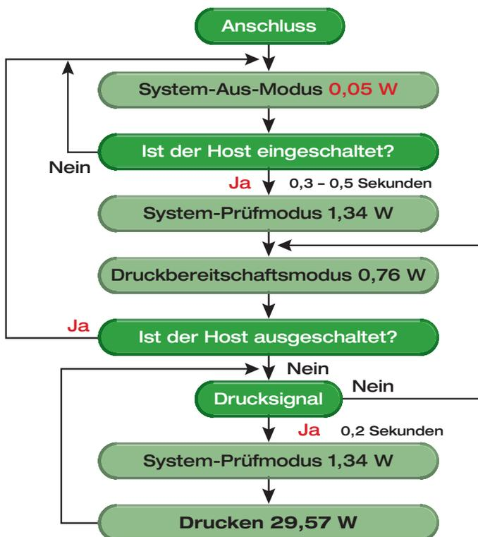
Die cleveren Entwickler bei Star haben diesen Drucker so konzipiert, dass er direkt mit dem PC kommuniziert, an dem er gerade angeschlossen ist. Die Benutzer werden als Erstes bemerken, dass es keinen Stromschalter gibt und der Drucker nur eingeschaltet werden kann, indem das mitgelieferte USB-Kabel am Drucker und PC/Terminal angeschlossen wird. Der Drucker wird erst aktiviert, wenn der PC/das Terminal hochgefahren werden; ansonsten bleibt er im energiesparenden Standby-Modus.
